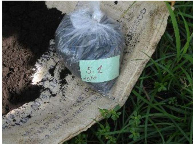
**Foto 41. Toma de muestra de suelo. Identificación de la muestra de suelo para envío al laboratorio.**
