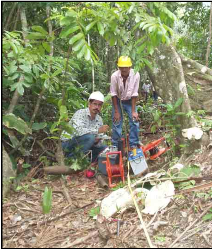
Figura No. 2.1.1-3 Ejecución de SEV en la comunidad de Mendoza
