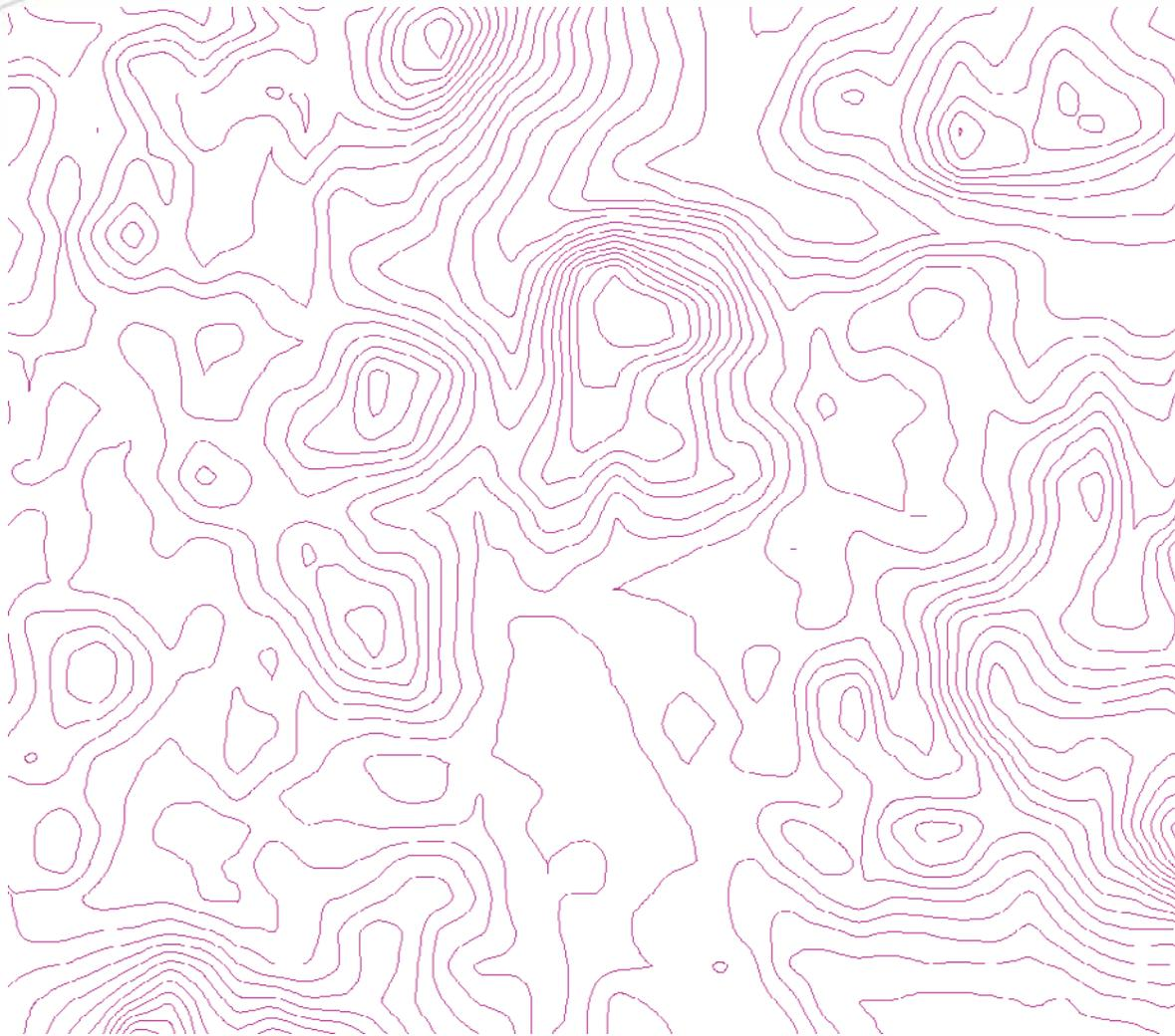
**Figura No. 9.** Curvas a nivel con intervalos verticales de 10 metros derivadas del modelo de elevación digital (suavizadas)
