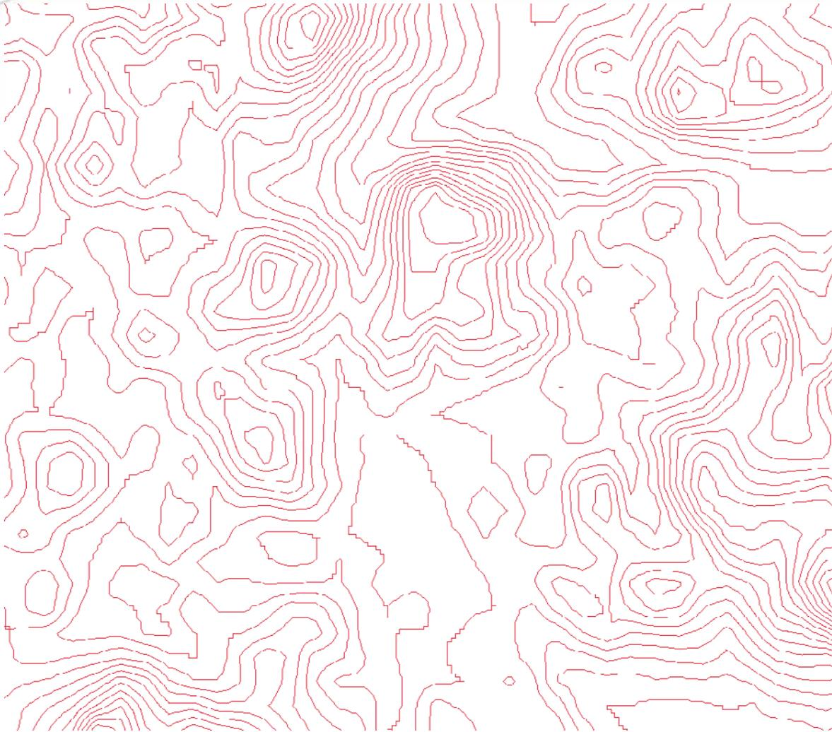
**Figura No. 8.** Curvas a nivel con intervalos verticales de 10 metros derivadas del modelo de elevación digital (sin suavizar)
