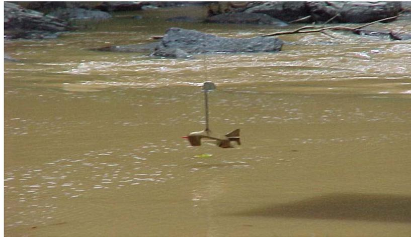
Figura 3. Muestreador de sedimentos suspendidos US DH59.
