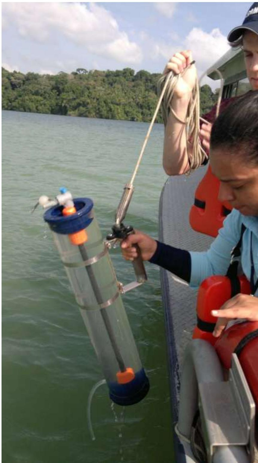
Figura 12. Muestreo de calidad de agua en la CHCP.
